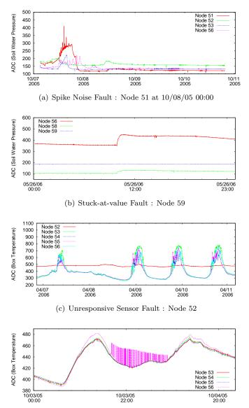
(d) Amplitude Fluctuation Fault : Node 56 between 10-03-05 18:00 to 10-05-05 07:00
