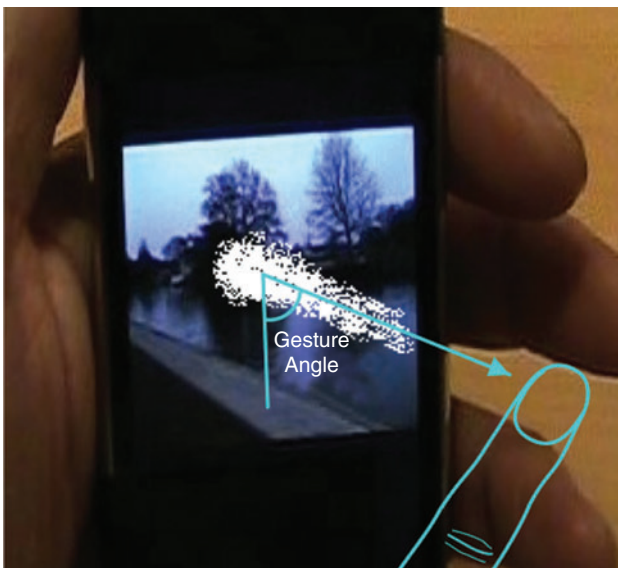
[图3] 识别一个手势。每个手势通过它在屏幕上的角度来识别。
